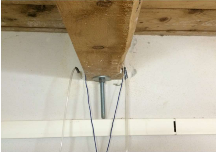
Abb. 39: Balkenanschluss mit erzwungener Konvektion
