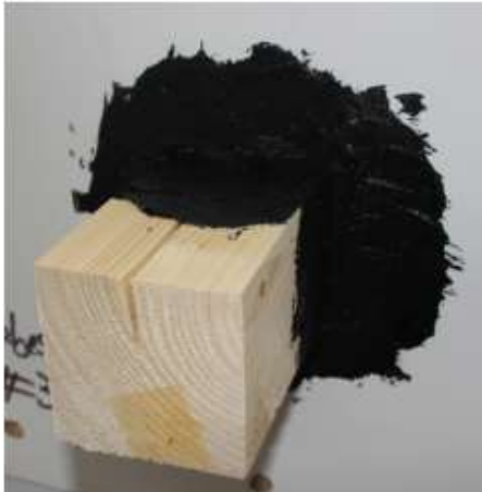
Abb. 25: Aufbringen der Dickbeschichtung
