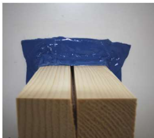
Abb. 27: Geringe Eindringtiefe in den Spalt
