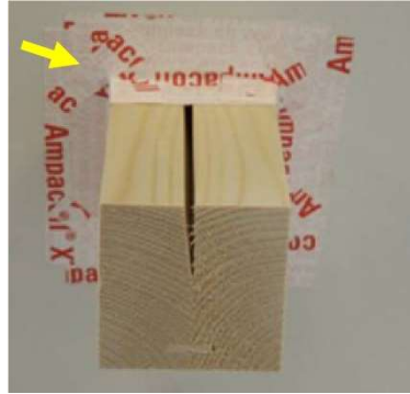
Abb. 21: Überlappung der Klebestreifen
