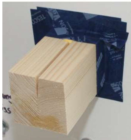
Abb. 32: Andichtung mit Klebeband
