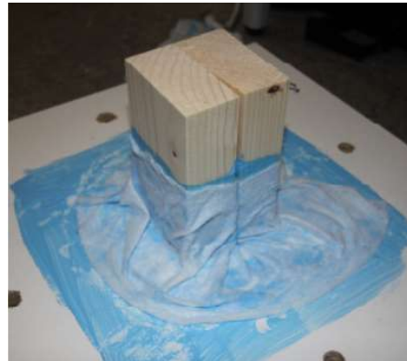
Abb. 29: Zweite Schicht und angebrachtes Vlies
