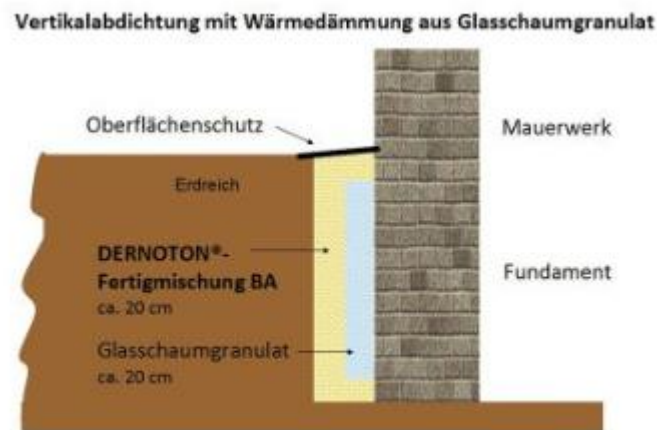
Abbildung 40 Detail Dernotondichtung mit Dämmung
